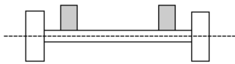
essieu traversant à roues simples
